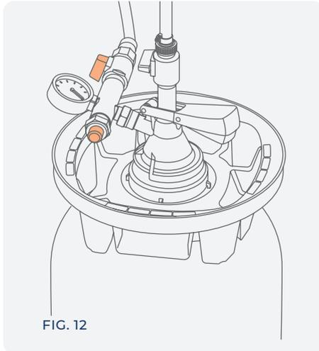
Schließen Sie den Regler und drehen Sie den Gashahn, um den Gegendruck auf einen Wert zu bringen, der etwas höher ist als der Produktfüllwert.
