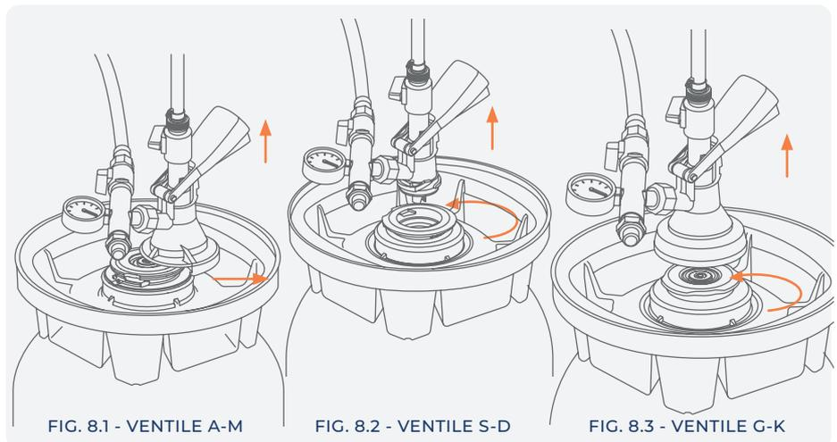
Öffnen Sie den Hebel schnell und trennen Sie den Anschluss vom Fass.
