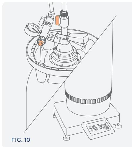
Öffnen Sie den Produkthahn, um mit dem Abfüllen zu beginnen, und drehen Sie den Gegendruckregler, um die Füllgeschwindigkeit einzustellen und/oder zu ändern.
