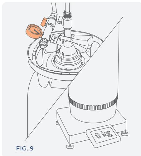
Drehen Sie den Gashahn bis der gewünschte Gegendruckwert erreicht ist (ca. 0,5 bar weniger als der Produktfülldruck).
