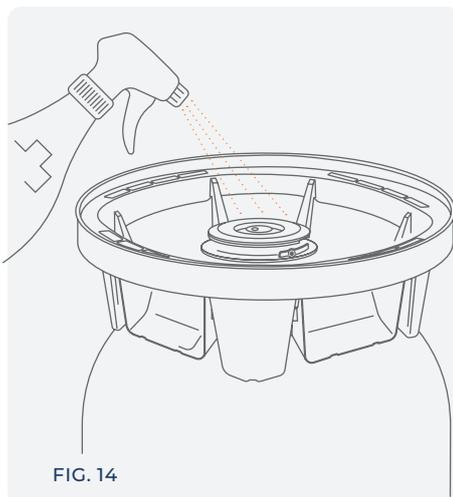
Entfernen Sie alle Produktreste mit Wasser, reinigen Sie den äußeren Teil des Ventils wie im Abschnitt "Sanitisierungsanweisungen" angegeben und trocknen Sie es.
