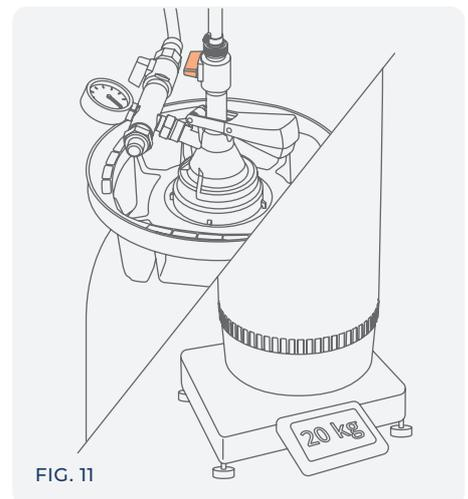
Wenn das Nominalfüllvolumen erreicht ist, schließen Sie den Produkthahn. Überschreiten Sie das nominale Füllvolumen nicht, so verhindern Sie das Auslaufen des Produkts aus dem Beutel.
