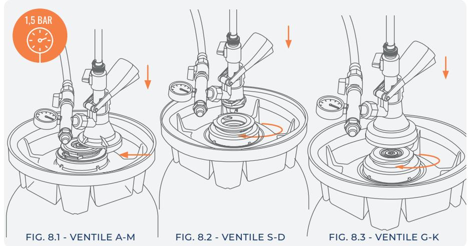
Schließen Sie den Abfüllkopf korrekt an das Ventil an, senken Sie den Hebel ab und überprüfen Sie den Fassinnendruck.
